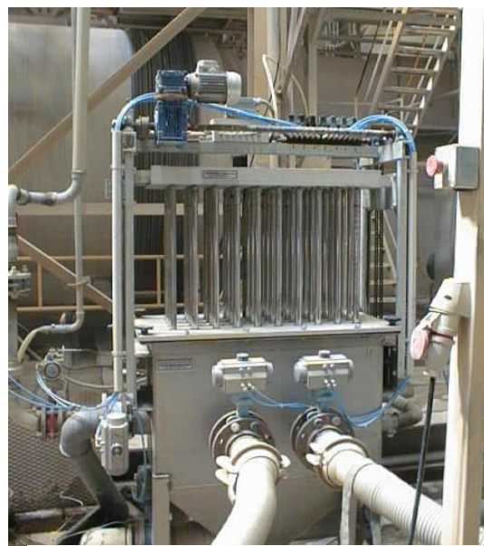
CVA.40.570.N10500 com as barras magnéticas no exterior, durante o ciclo de limpeza
